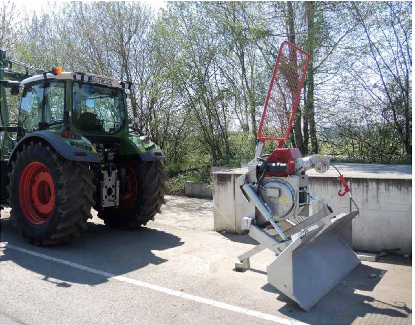
Les treuils à adaptation directe permettent encore une importante force de traction avec des tracteurs compacts Ceci est obtenu par un montage bas sur le tracteur. L'entraînement s'effectue directement par la PDF du tracteur. La basse position de montage donne en outre une stabilité optimale et une vue dégagée sur les béquilles depuis la cabine.
