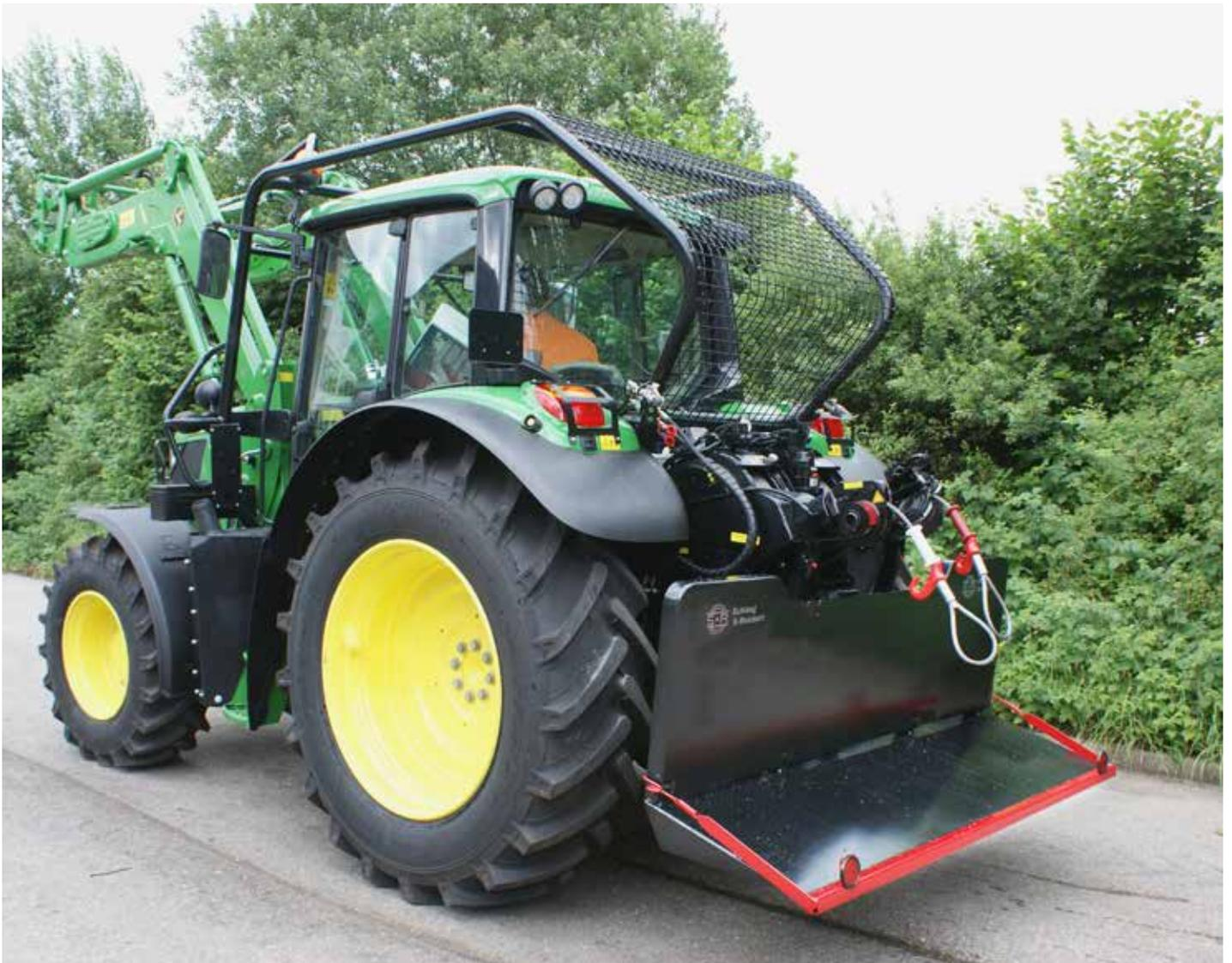
Si un treuil forestier est utilisé au quotidien, il est recommandé de choisir un treuil à adaptation rapide ou fixe de Schlang & Reichart. La raison en est la différence de montage du treuil et des supports d'appui sur le tracteur, libérant ainsi ce dernier d'une grande partie du poids lors du rapprochement des grumes.
