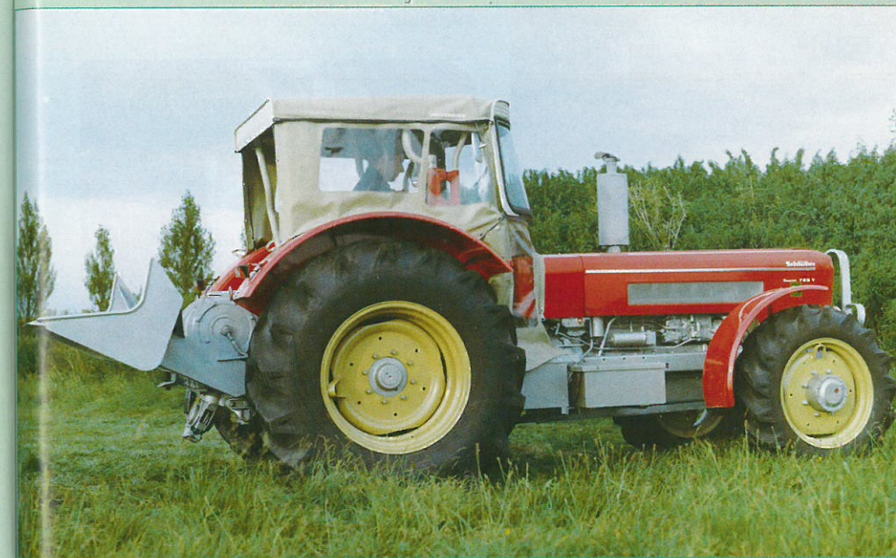
FW 51 mit früher Ausführung der Tragbergstütze: Angebaut ist die 6-Tonnen-Winde am Schlüter Super 750 V.
