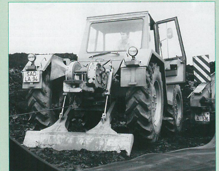
Systemschlepper im Braunkohle-Tagebau von Schwandorf, Oberpfalz: Kramer 1014 mit FW 51 R im Heckanbau.
