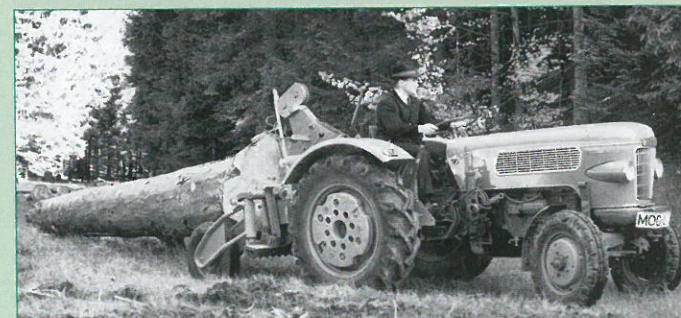
Mehrzweck-Forstgerät: Hier ein Fendt Farmer 2D (28 PS) mit einseitig angehobenem Stamm beim Abtransport.
