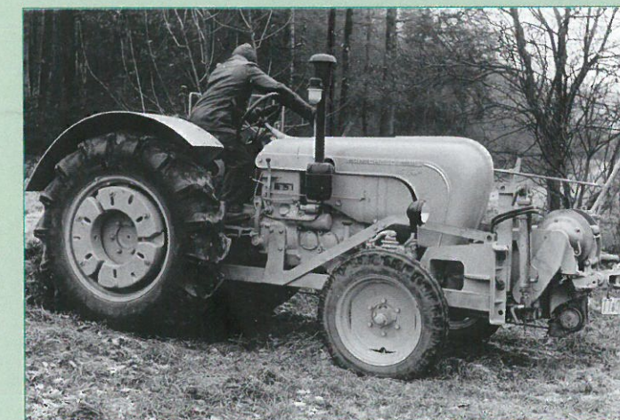
Seltene Ausrüstung: Porsche Diesel Super mit Belastungsgewichten und S & R-Winde FW 5 im Frontanbau.
