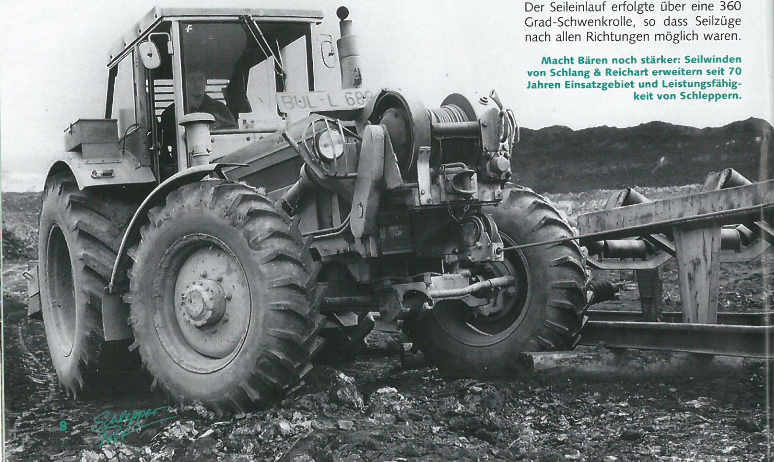
Seltene Ausrüstung: Porsche Diesel Super mit Belastungsgewichten und S & R-Winde FW 5 im Frontanbau.
