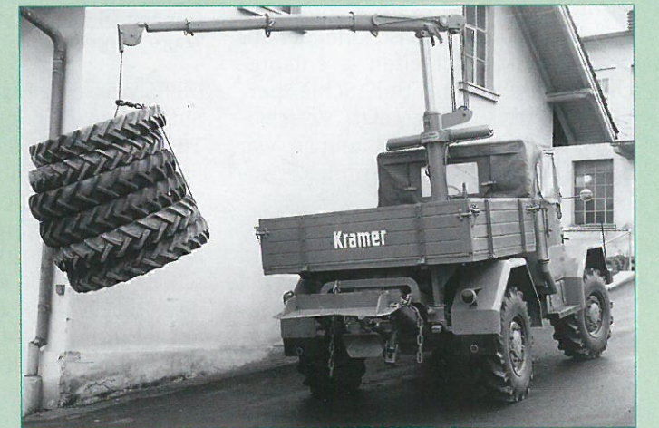
U 800 für alle Fälle: In Überlingen abgelichtete offene Kramer-Zugmaschine mit Ladekran und S & R-Seilwinde.
