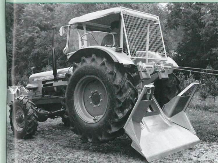
Spezielle Ausrüstung: Dieser Eicher Mammut Allrad ist mit der Zwilling-Winde 260 im Frontanbau bestückt.
