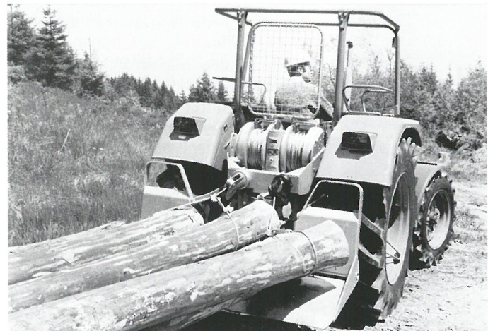
Zieht ordentlich was weg: 2 x 5 Tonnen maximale Nutzlast packt diese Doppeltrommel-Seilwinde der Allgäuer.
