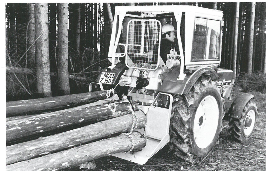
Allradler aus Neuss: IHC 633 mit fest angebauter Zwillings-Seilwinde für 2 x 2,5 Tonnen mittlere Nutzlast.
