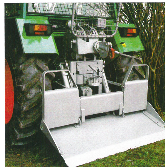
Durchgehender Motor- und Getriebeschutz: Fendt bot für Forstkunden ein komplettes Sicherheitspaket an.
