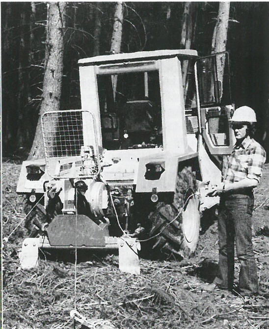
Nicht von der Stange: S & R Doppeltrommel-Winde 231 am Heckkraftheber eines frühen MB-trac.
