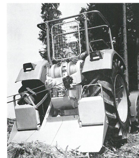
Fendt mit Überrollrahmen: Die 250er Zwillings-Winde besitzt eine kräftig dimensionierte Tragbergstütze.
