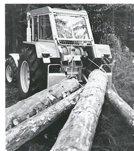
Festanbau für Profis: Schlüter mit 2 x 7 Tonnen Doppeltrommel-Aggregat mit höhenverstellbarem Seileinlauf.
