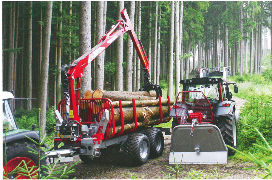
Moderne Zeiten: Silbergrau mit Rot dominiert das Erscheinungsbild der aktuellen S & R-Gerätepalette – der Forst-Kran 80.52 besitzt acht Meter Reichweite.
