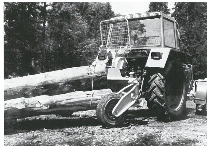
Safety first: Verbesserter Rückewagen 31.2 mit typischen Stützrädern und hydraulischer Schaltung.
