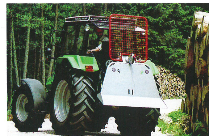
Neue Optik: Seit Ende der 1980er Jahre besitzen die Dreipunkt-Winden ein hohes, „geschlossenes“ Rückeschild.
