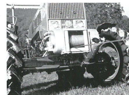
Von einem Ölmotor angetrieben: Selbstbergwinde Typ 126 am Vierradgetriebenen Fendt Farmer der 100er Serie.
