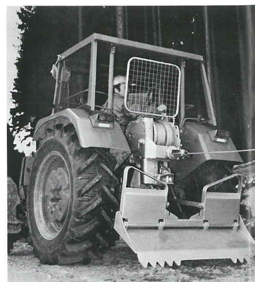
▼ Neues Gehäuse, eigene Ölpumpe: 1974 startete die 710er Festanbau-Winde mit sieben Tonnen maximaler Nutzlast.
