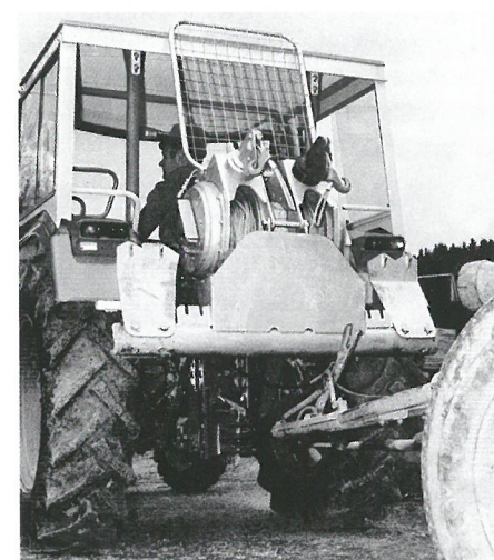
Flexibler Dreipunkt-Anbau: Für Anhänger-Betrieb wird die Winde nach oben gefahren.
