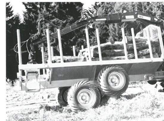
Gut im Gelände: Ein Bogie-Achsaggregat hilft dem Rückeanhänger über Baumstümpfe und andere Hindernisse.
