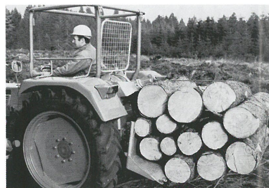
▲ Auch Kurzholz-Transporte werden erledigt: Eintrommel-Aggregat 510 mit vielseitig nutzbarem Rückeschild.
