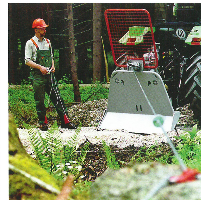
Kundenwunsch: Kabel-Fernbedienung mit elektrischer Drucktastensteuerung gabs gegen Aufpreis.
