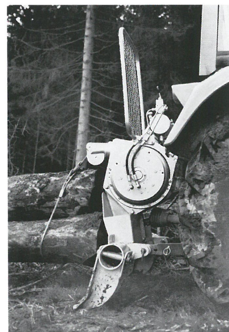
Sonderaufbau aus Marktoberdorf: Allrad-Schlüter im Dienst der damaligen Bayerische Braunkohlen Industrie AG mit FW 51-Winde im Frontanbau.
