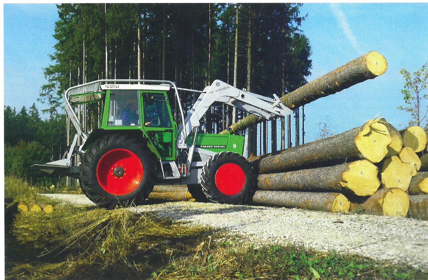
Mit Frontpolderschwinge und Kabinen-Schutzgitter: 40 km/h-Allradsschlepper Farmer 308 LSA mit 78 PS.
