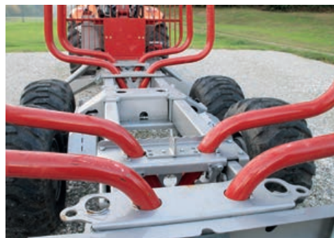
Doppelrohrrahmen mit verschiebbaren Rungenstöcken und Achsaggregat.
