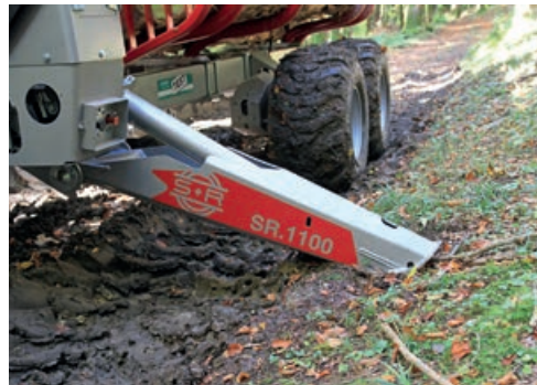
Die Flap-Down-Abstützung beim S&R-Kran ist breiter als die A-Stützen bei Pfanzelt.
