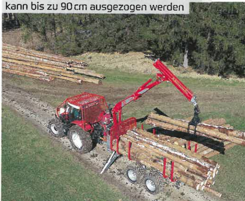
Die Grundlänge der Ladefläche sind 4 m und kann bis zu 90 cm ausgezogen werden
