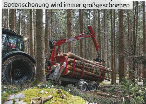
Die Grundlänge der Ladefläche sind 4 m und kann bis zu 90 cm ausgezogen werden
