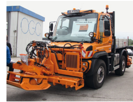
Unimog U 423, Kipppritsche mit Sichtdreieck KP 423, AS Baugeräte
