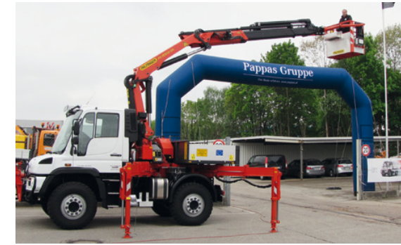
Unimog U 423, Kranaufbau Palfinger PK 18001, Gerätehersteller Werner
