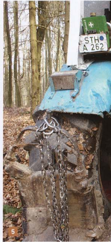
Abb. 4: Die Anbaseilwinde Typ 270 mit 2x7 t Zugleistung stammt von Schlang & Reichart.
