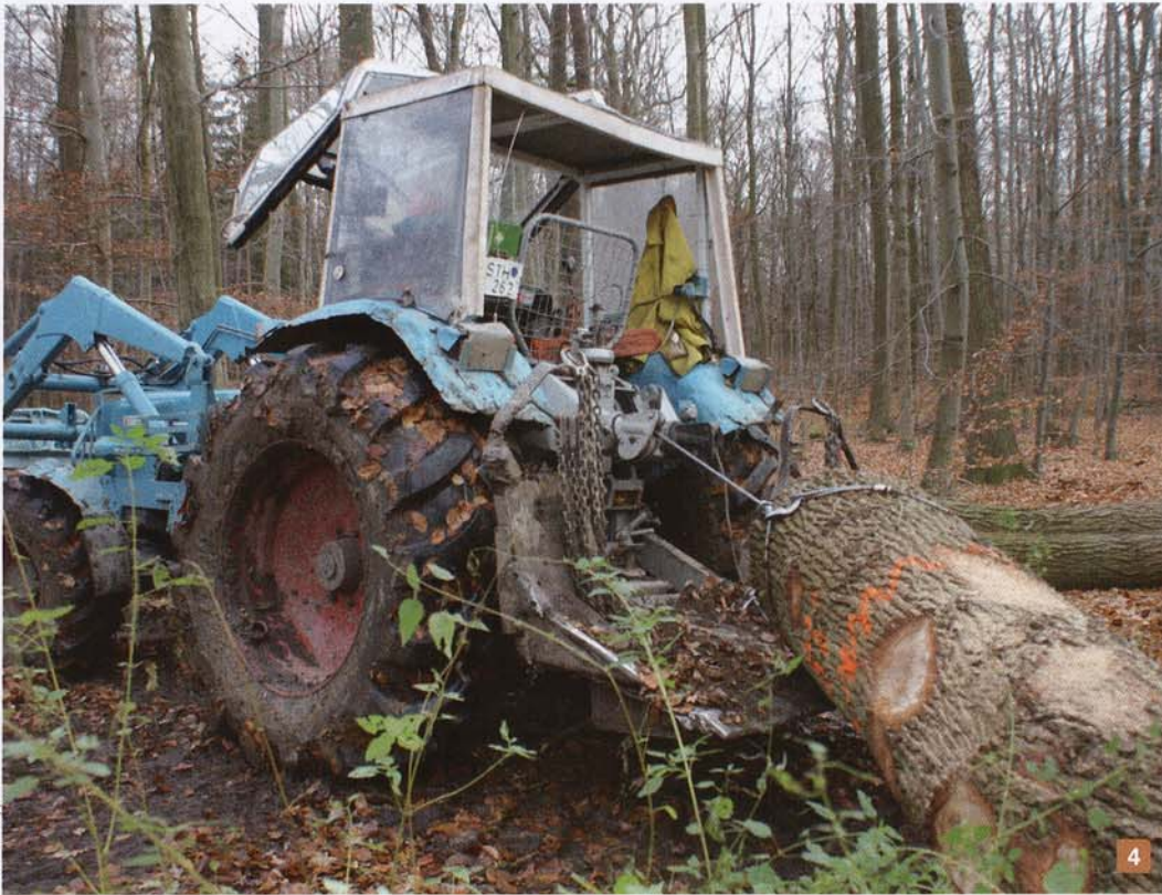
Abb. 4: Die Anbaseilwinde Typ 270 mit 2x7 t Zugleistung stammt von Schlang & Reichart.
