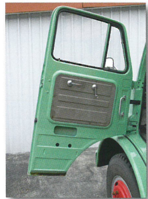
Nix als nacktes Blech: Die rustikale Fahrertür spart deutlich an Material.
