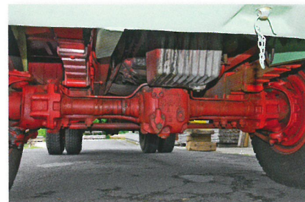
Filigran wirkende Ritzelachse: Die angetriebenen Vorderräder gewährleisten Vortrieb in allen Lebenslagen.
