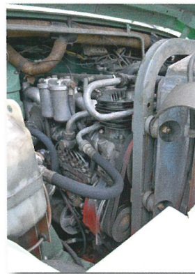
Ergibt genau 6 PS pro Tonne: 156 PS starker 71-Motor D 0836 HM 70.
