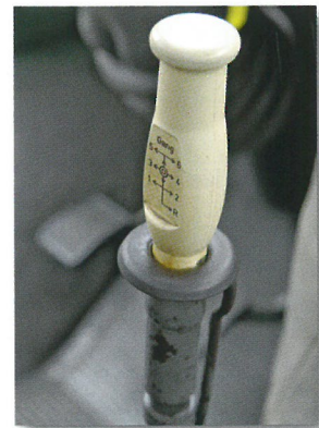
Typisch für MAN: Die Schalthebeln liegen übereinander.
