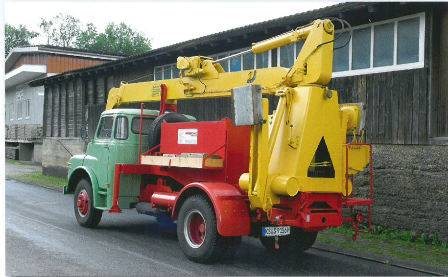
Hecklastig: Ganz am hinteren Ende sitzt der Schlang & Reichart-Kran Typ 40.1 für 4,9 t Traglast, in der roten Kiste davor verstecken sich 5 t Gegengewicht.
