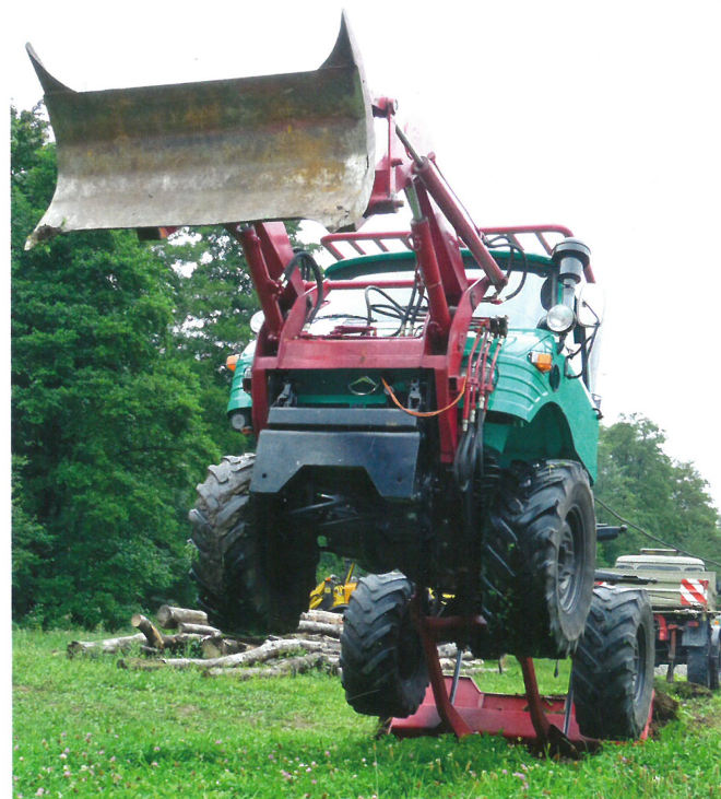
Nachgestellt: Historischer Unimog 406 mit Werner Doppelwinde legt sich ins Zeug. Das kam früher schon mal vor. Da mußte die Windenbremse feinfühlig steuerbar sein. Sonst konnte man sich leicht die Vorderachse demolieren. Fotos: Lindemann
