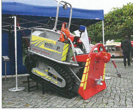
Bergeraupe: Das Forsttechnikfahrzeug kann überall dort eingesetzt werden, wo eine Seilwinde zur Bergung oder Sicherung benötigt wird.
