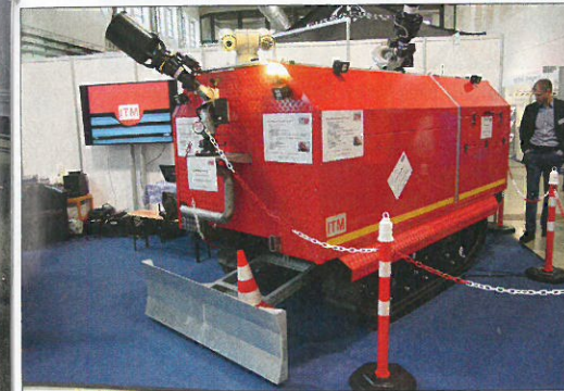
Lösch-Kettenfahrzeug: Das fernsteuerbare LKF 17/20 von ITM eignet sich zur Wald- und Industriebrandbekämpfung.
