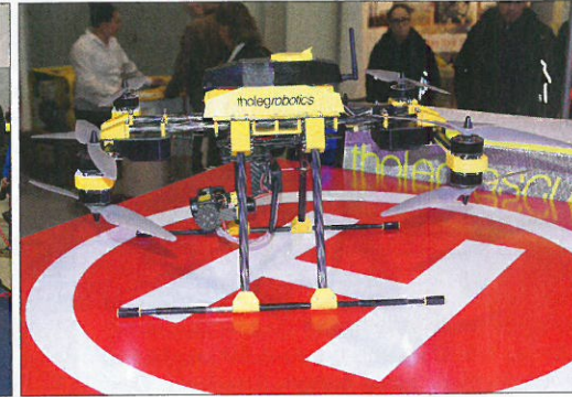
Waldbrand-Drohne: Der Octocopter von Tholog Robotics detektiert selbstständig Wald- und Flächenbrände. Das Nachladen erfolgt über Induktion.
