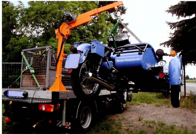
Ladekran HUMMEL GSK 500 auf einem Servicefahrzeug. Der Tragarm ist einschiebbar von 1200 mm auf 760 mm (ARPO Arthur Prokroppa).
