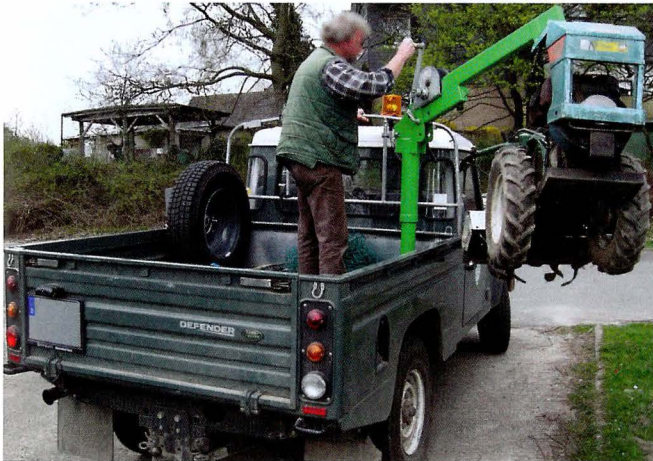
Variante mit Kurbelseilwinde und fester Länge des Arms – der HUMMEL GALA 500 von ARPO.
