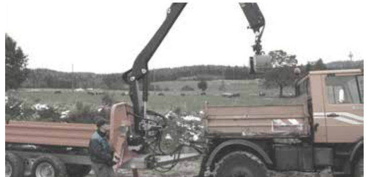
Le mécanisme d'orientation pivotant à 370° permet également le chargement depuis l'Unimog.
