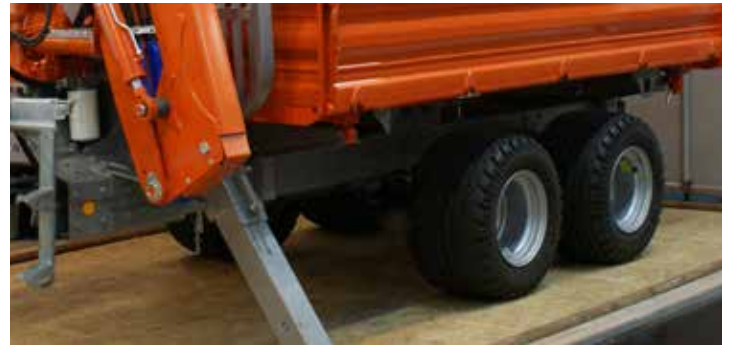
Stabilisateur en A pour une stabilité optimale avec un minimum d'encombrement.
