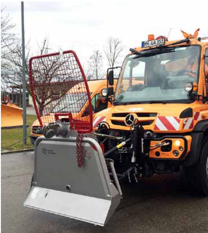
Treuil frontal avec lame avant.
