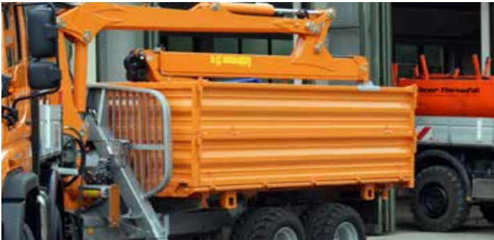
Les fixations de paroi latérale augmentent la capacité de chargement et sont disponibles par écartement de 50 cm.
