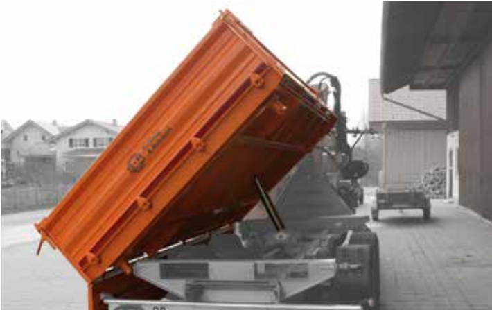
Pont basculant de 3 côtés avec deux rampes intégrées dans le cadre.
