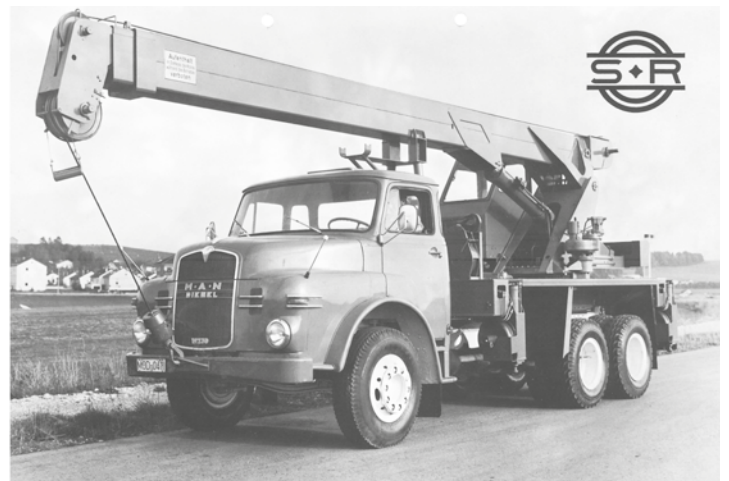
Grue mobile télescopique sur camion, type MT16, années 1970, avec une puissance de levage de 10 tonnes maximum.
